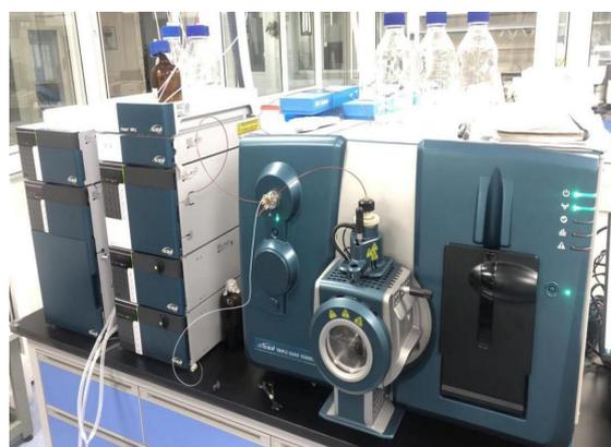
图 1 检验科装备的 AB SCIEX Triple Quad™ 4500MD 串联质谱仪
