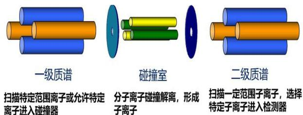
图 2 三重四级杆串联质谱的内部结构模式图
